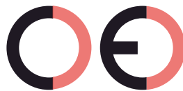
Marca CE falsa (demasiado separados)
